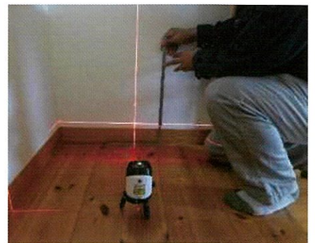
「床の傾きを計測する」調査機器
